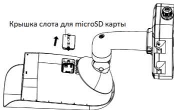
Рисунок 2-1 Демонтаж крышки слота для карты памяти (камера I типа)
