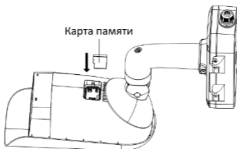
Рисунок 2-2 Установка карты памяти (камера I типа)
